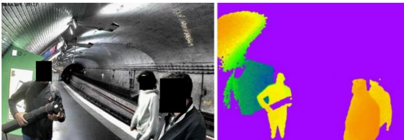
Comparaison d'images de la même scène issues d'une caméra classique (à gauche) et d'un capteur temps de vol (à droite) – Source : RATP
